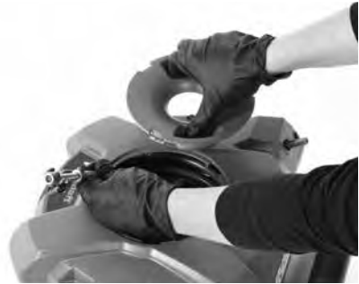
Figura 7B - Recupero del demolitore a catena/cavo
