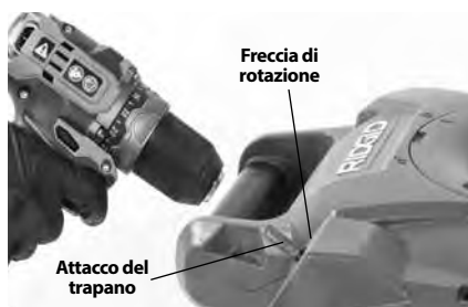
Figura 4 - Collegamento del trapano al perno di attacco
