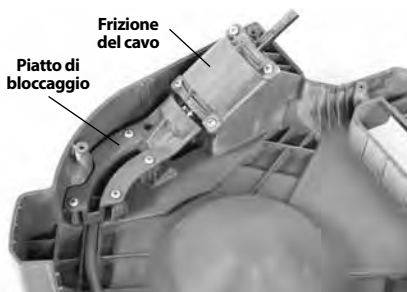
Figura 18 - Alloggiamento superiore della stasatrice rimosso
