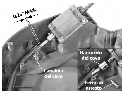
Figura 19 - Installazione del cavo di ricambio
