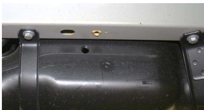
Raccordo di aspirazione, foro filettato predisposto
