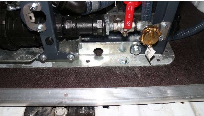
Anteriore destro, 1x M10 con contropiastra e controdado
