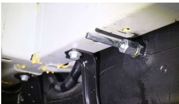
Raccordo di aspirazione, tubo di immersione montato.
