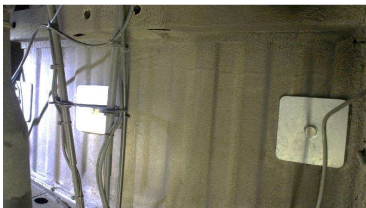
Fissaggio posteriore, 3x M10 con Loctite 243 e contropiastre lato inferiore.
