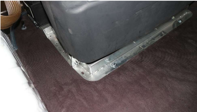
Posteriore, 2x M10 con contropiastra e controdado.
