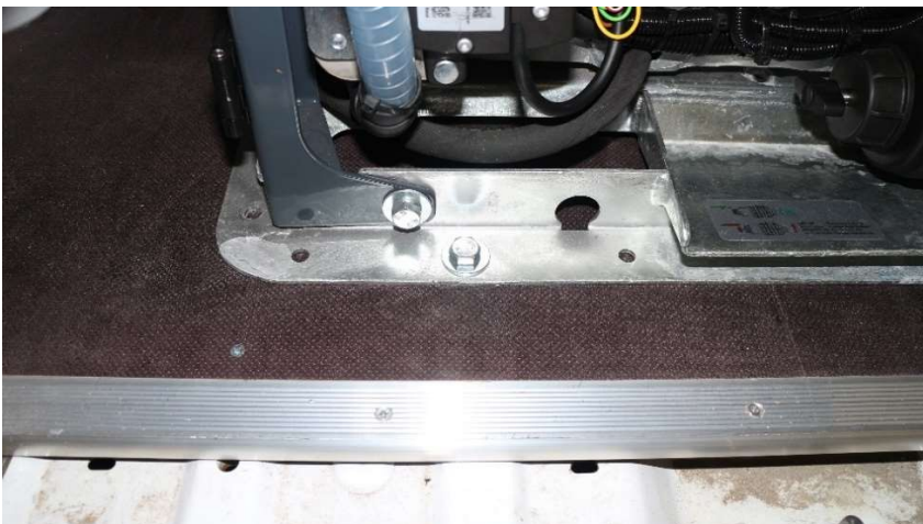
Anteriore sinistro, 1x M10 con contropiastra e controdado
