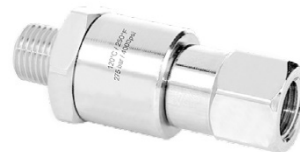
Giunto rotante 1/2" M 1/2" F 275 bar (5030.83-04)
