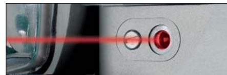
▲ Misurazione diametri e deformazioni con laser integrato
